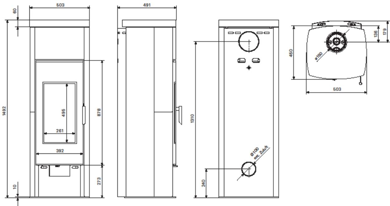
**Hinweis:** Achten Sie darauf, dass sich der obere Rauchrohranschluss des Schmitzker Kaminofen Aqua auf einer Höhe von 1085 mm befindet. Planen Sie also zusätzlich ein Rauchrohr entlang der Speichersteine ein.
