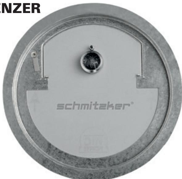
■ **FUNKTIONSPRINZIP** Der Schmitzker Kaminzugbegrenzer ist eine selbstständige Nebenluftvorrichtung für einen konstanten Schornsteinzug und dient der Trockenlegung des Schornsteins von Öl-, Gas- oder Festbrennstoff-Feuerungsstellen. Er ist für den Einsatz an Schornsteinen mit einem Durchmesser von 120 bis 200 mm (mittels entsprechender Stützen) oder auch an gemauerten Schornsteinen sowie Formsteinen oder mehrschaligen Schornsteinen (mittels Kaminhülse) geeignet.
